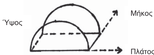
Σχήμα 5. Βασική κατασκευαστική μονάδα τοξωτού
